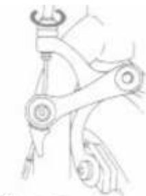
rys. 12b regulacja napięcia linki hamulca
