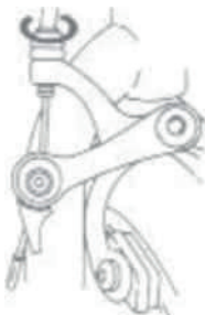
rys. 12b regulacja napięcia linki hamulca
