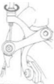
rys. 12b regulacja napięcia linki hamulca
