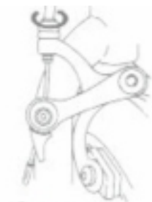
rys. 12b regulacja napięcia linki hamulca
