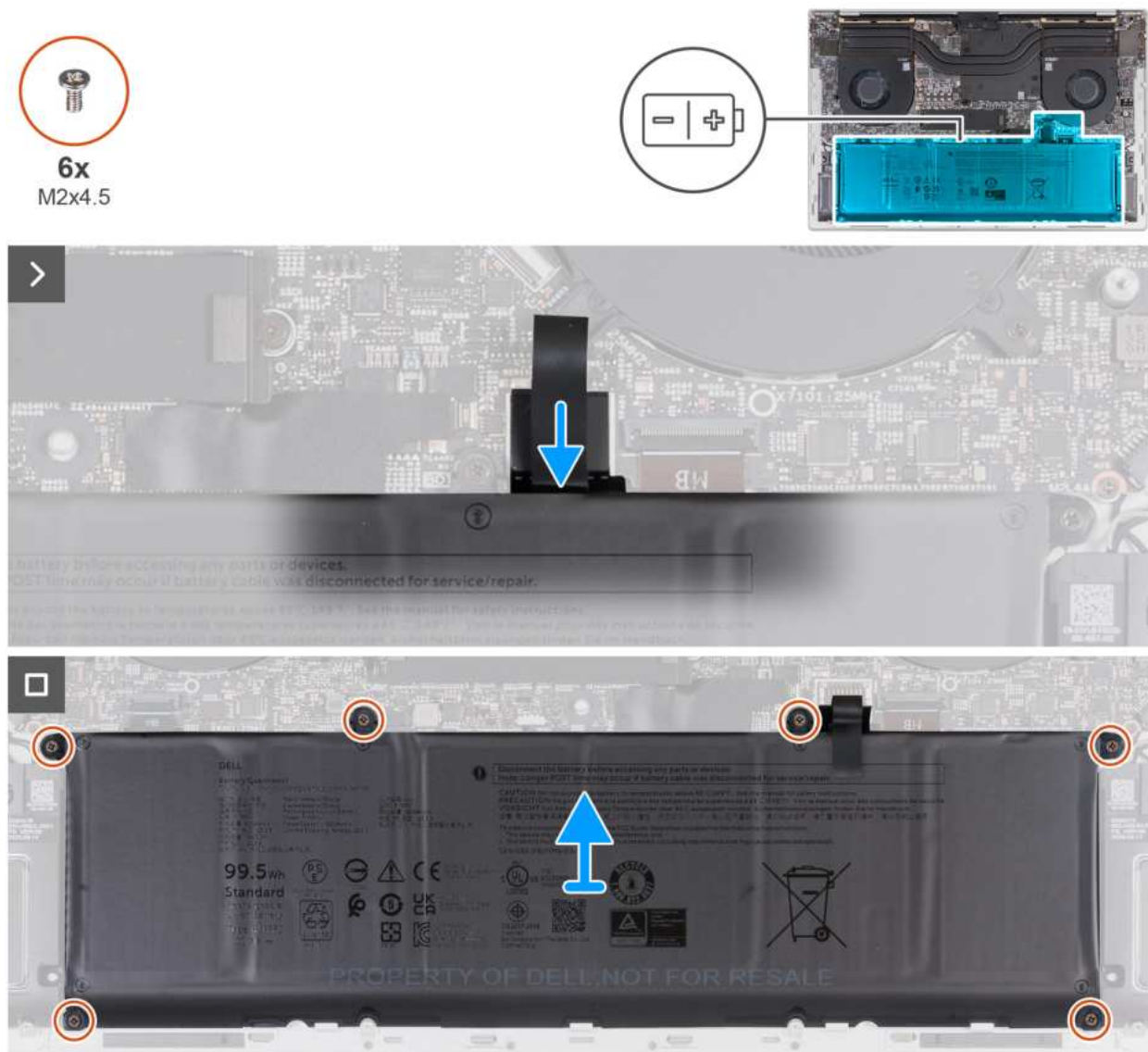
Rysunek 19. Wymontowywanie baterii
