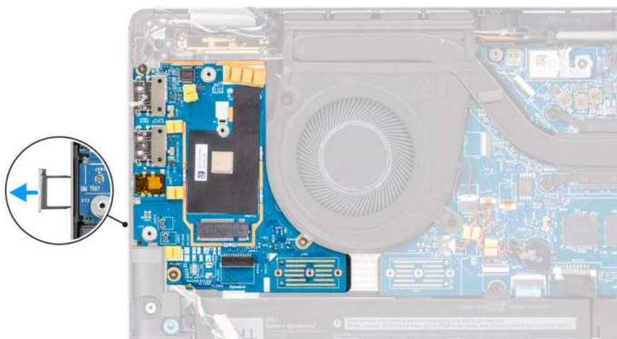
Rysunek 13. Wymontowywanie karty towarzyszącej we/wy
