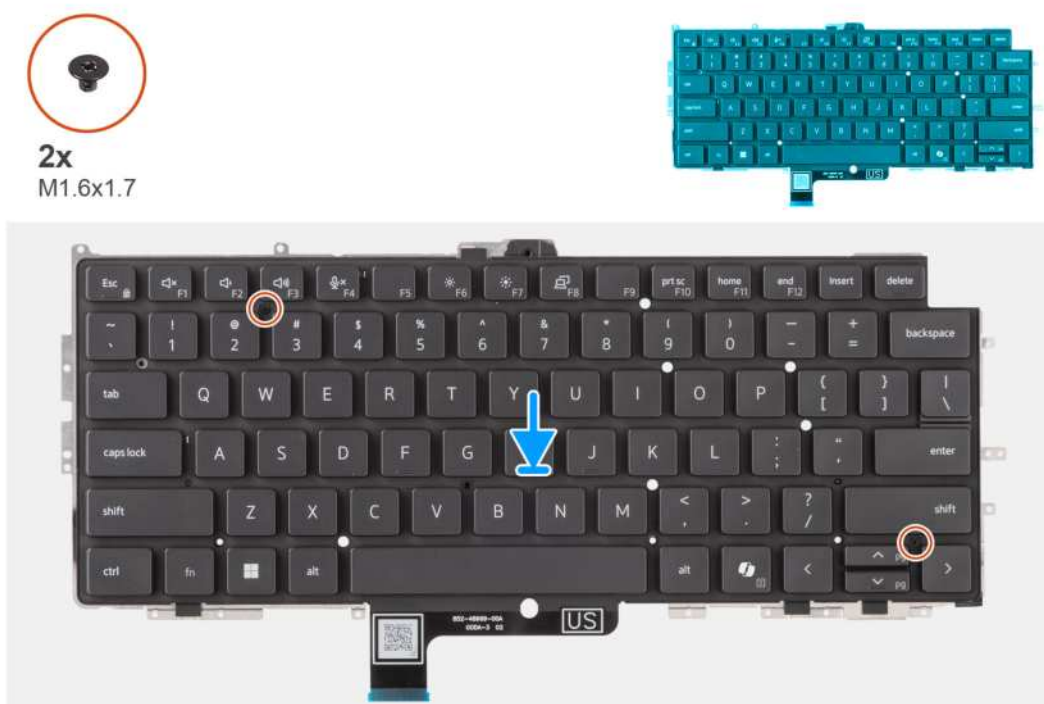
Rysunek 79. Instalowanie klawiatury
