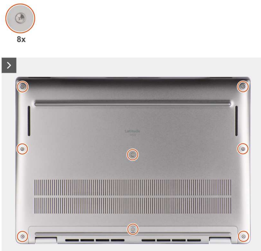
Rysunek 15. Wymontowywanie pokrywy dolnej
