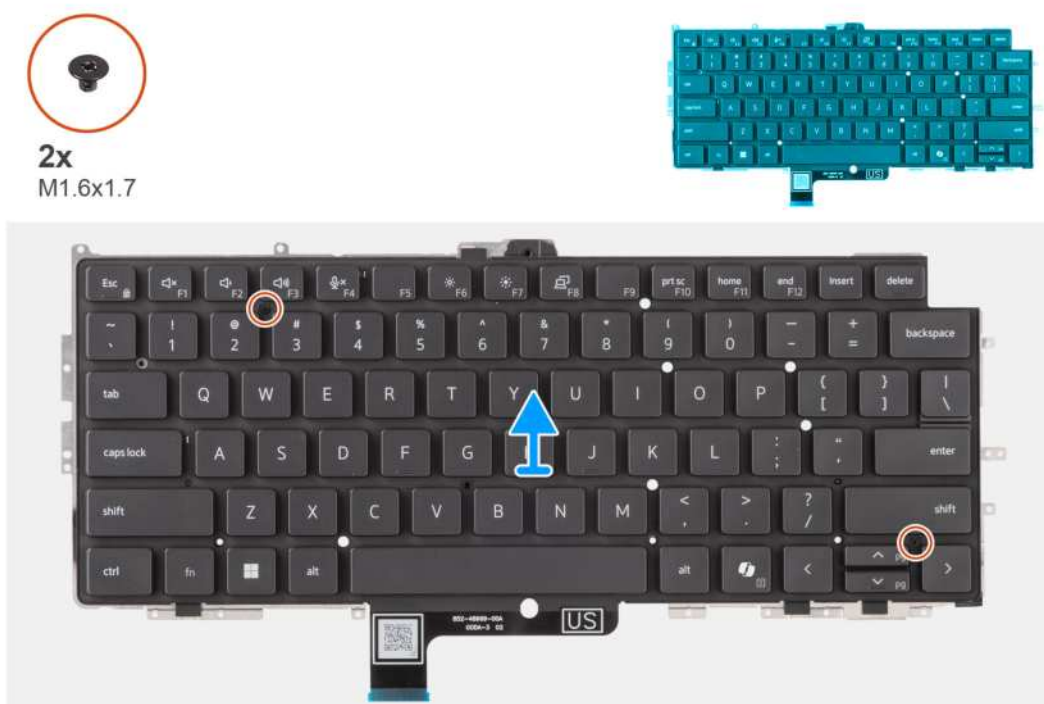
Rysunek 76. Wymontowywanie klawiatury
