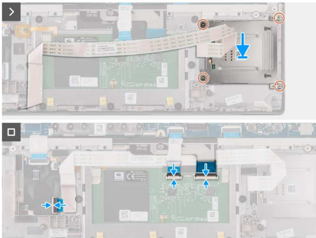
Rysunek 54. Instalowanie czytnika kart smart
