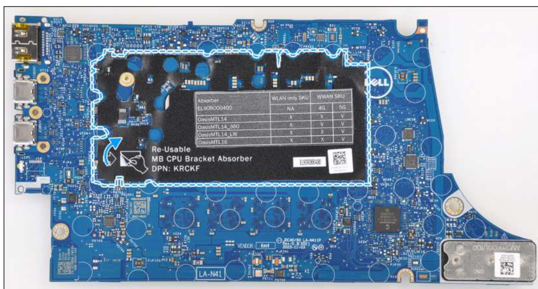
Rysunek 59. Element pochłaniający klamry procesora
