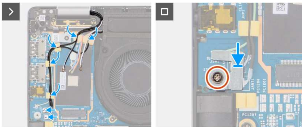
Rysunek 52. Instalowanie zestawu wyświetlacza
