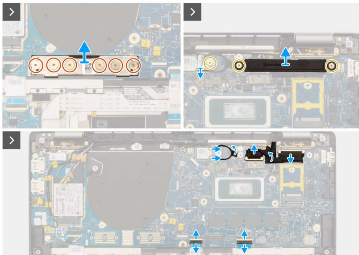
Rysunek 56. Wymontowywanie płyty głównej
