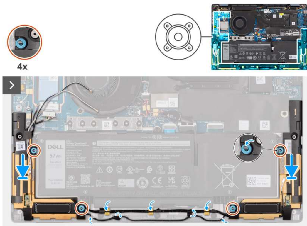
Rysunek 28. Instalowanie głośników — dotyczy komputerów w konfiguracji Ultralight
