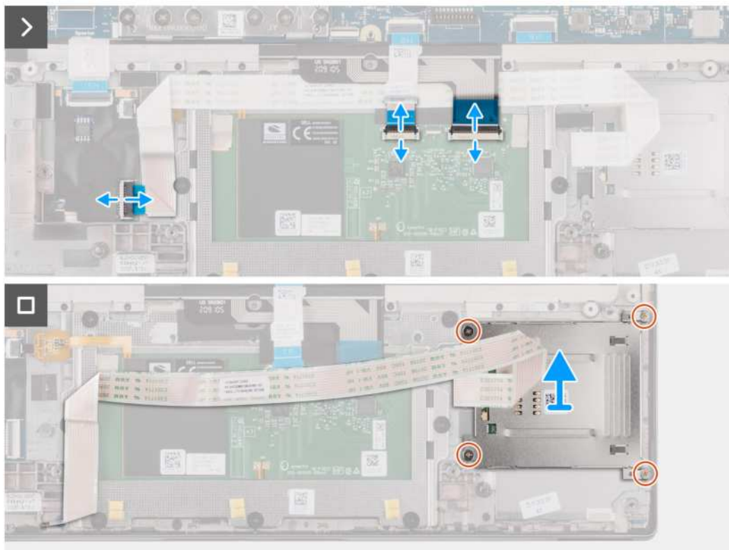
Rysunek 53. Wymontowywanie czytnika kart smart
