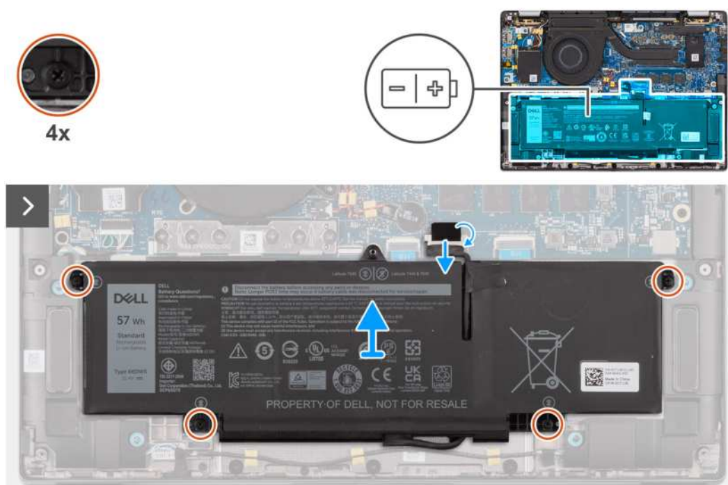
Rysunek 37. Wymontowywanie baterii 3-ogniowej
