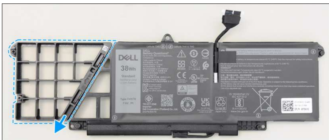
Rysunek 35. Wymontowywanie baterii 2-ogniowej
