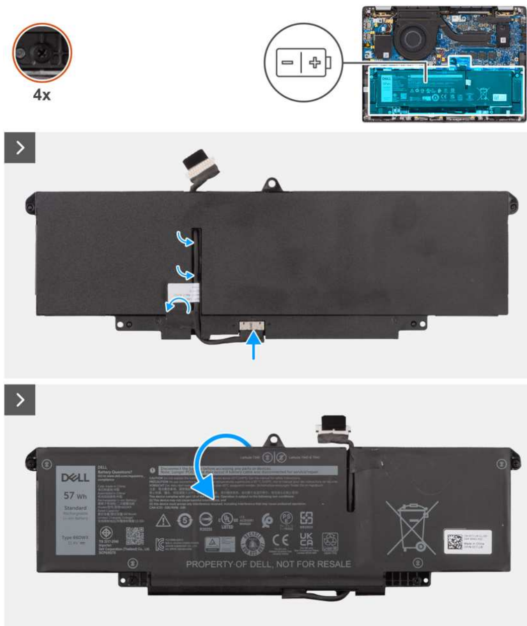
Rysunek 42. Instalowanie kabla baterii
