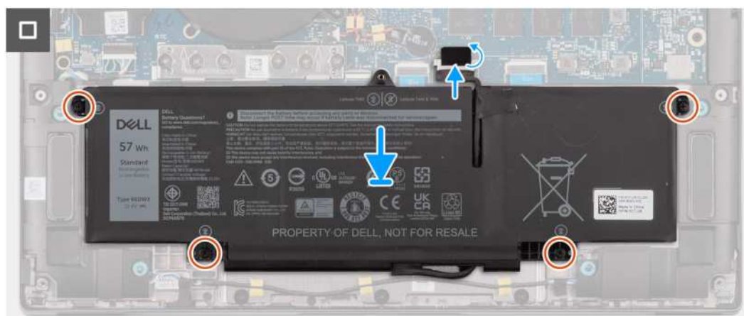
Rysunek 40. Instalowanie baterii 3-ogniowej
