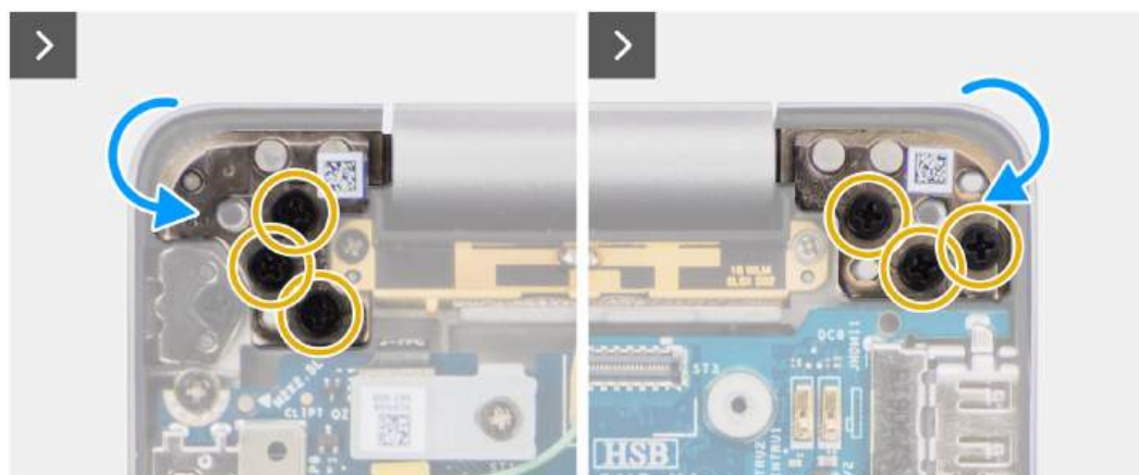
Rysunek 40. Instalowanie zestawu wyświetlacza
