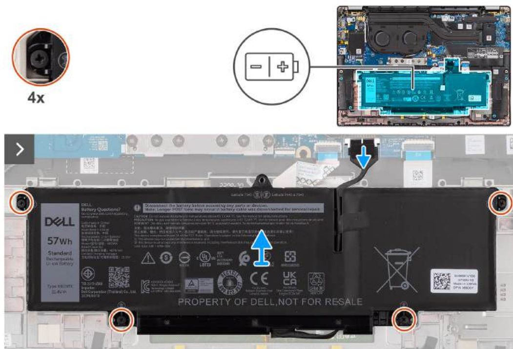
Rysunek 29. Wymontowywanie baterii 3-ogniowej
