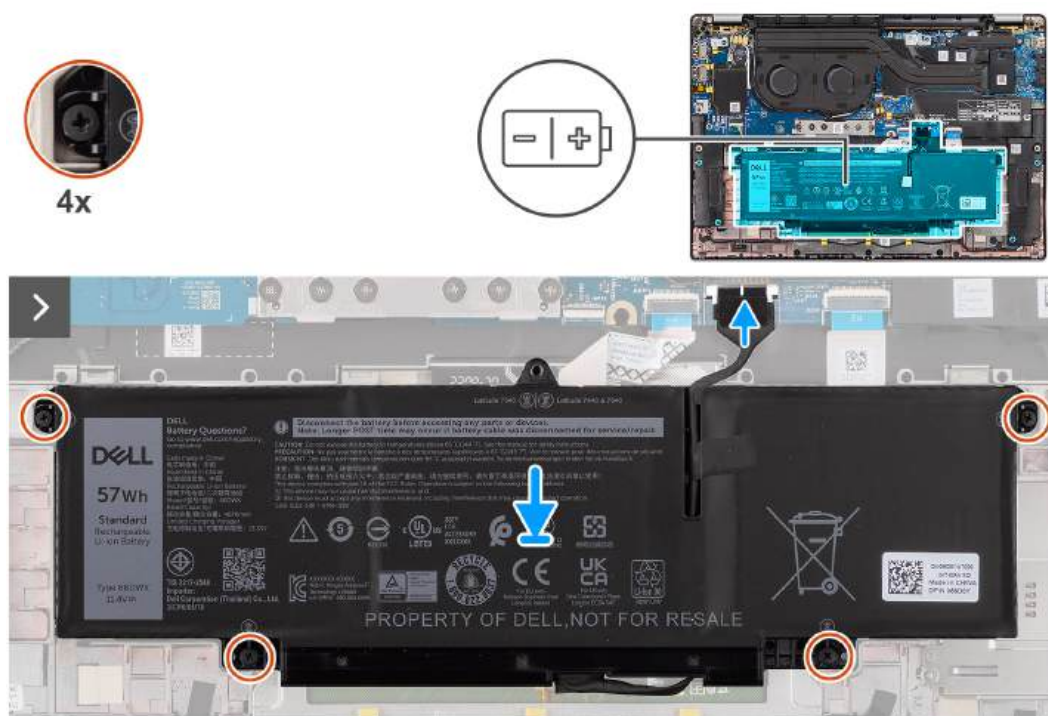
Rysunek 30. Instalowanie baterii 3-ogniowej
