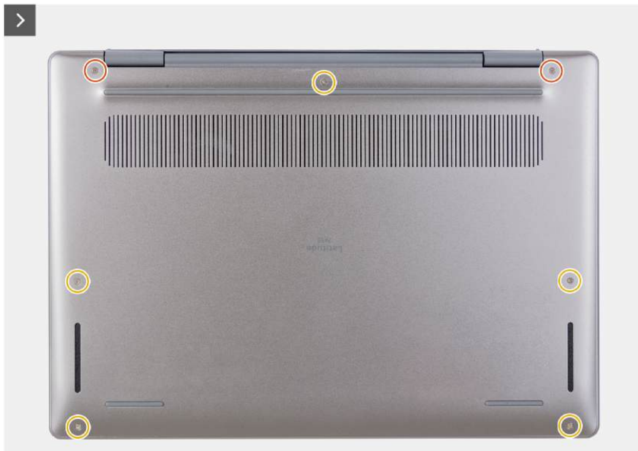
Rysunek 15. Wymontowywanie pokrywy dolnej
