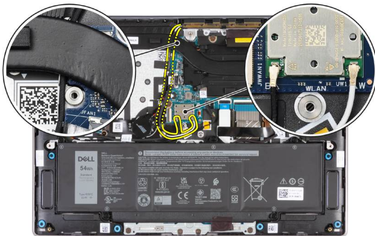
Rysunek 62. Instalowanie kabli anteny sieci WLAN
