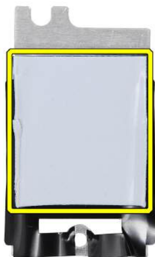
Rysunek 22. Podkładka termoprzewodząca pod osłoną termiczną dysku SSD
