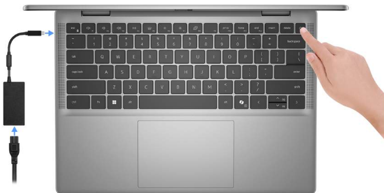
Rysunek 7. Podłącz zasilacz i naciśnij przycisk zasilania
