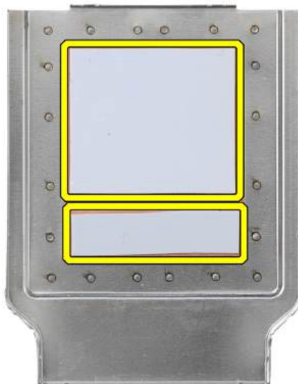
Rysunek 27. Podkładki termoprzewodzące u dołu osłony termicznej karty sieci WWAN
