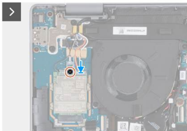
Rysunek 28. Instalowanie karty sieci WWAN 5G
