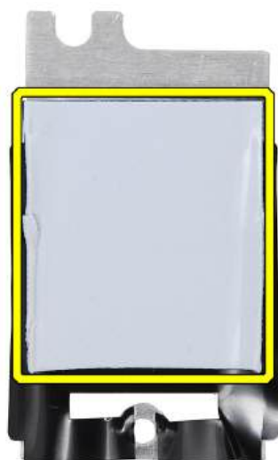
Rysunek 24. Podkładka termoprzewodząca pod osłonę termiczną dysku SSD
