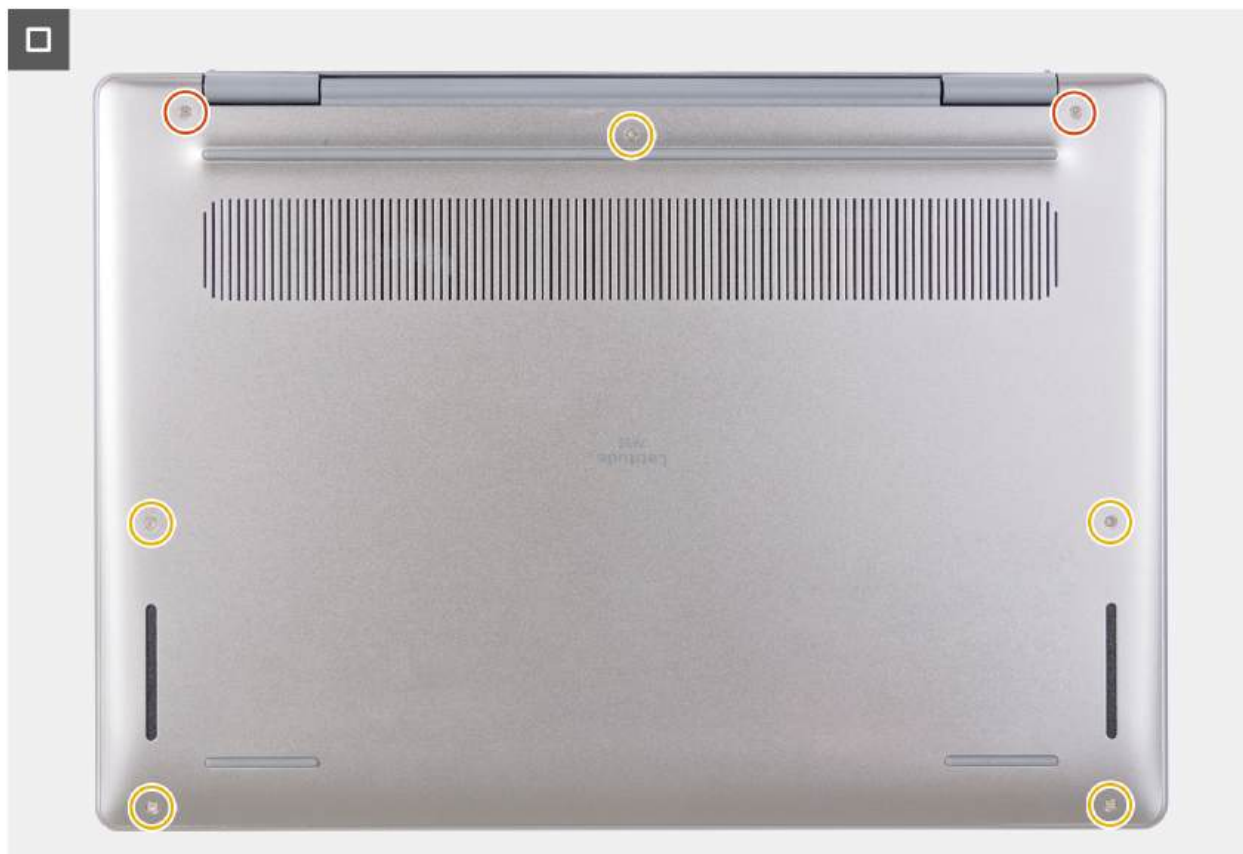
Rysunek 20. Dokręcanie i wymiana śrub
