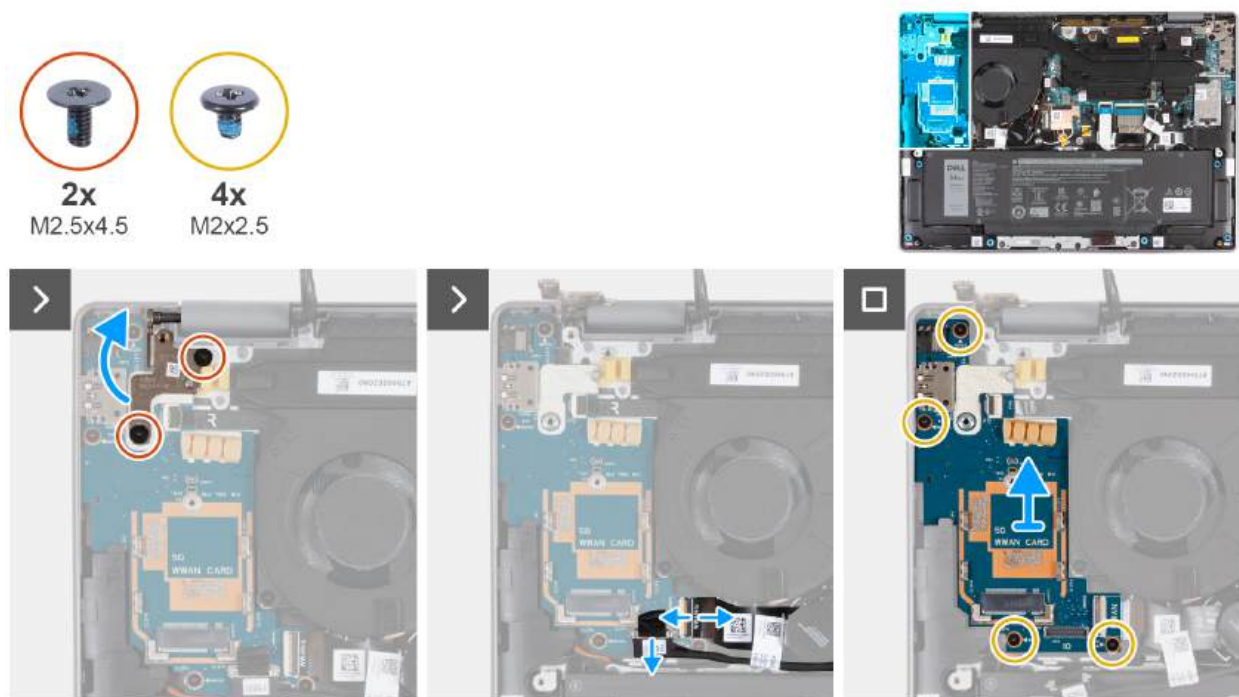
Rysunek 84. Wymontowywanie płyty we/wy (dotyczy komputerów dostarczanych z obsługą sieci WWAN)
