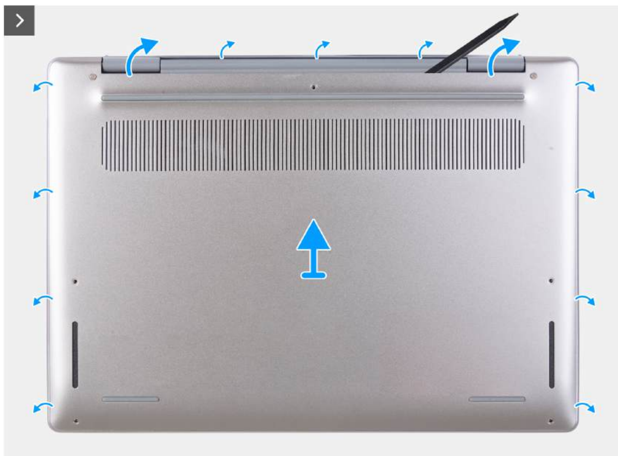
Rysunek 16. Wymontowywanie pokrywy dolnej
